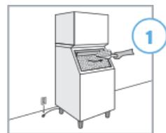
Desenchufe la máquina. Elimine y deseche todo el hielo. Reemplace el filtro de agua si la máquina de hielo ha estado apagada durante más de 4 semanas.
